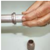
Sealing into conduit. Introducir la junta de vedación en el electroducto.
