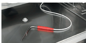
Sonda de controle no coração do alimento.
